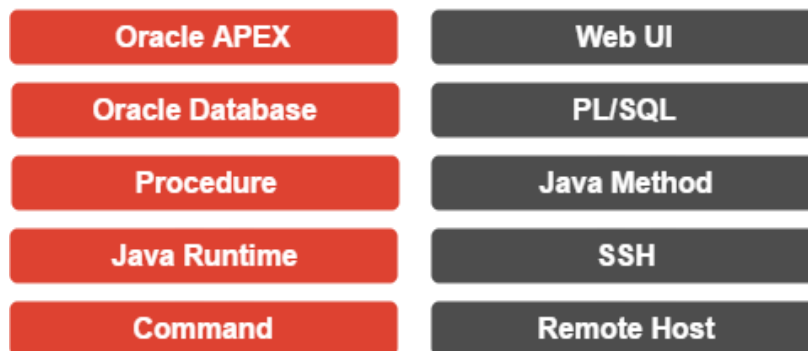
Ilustración 14: Capas de ejecución
