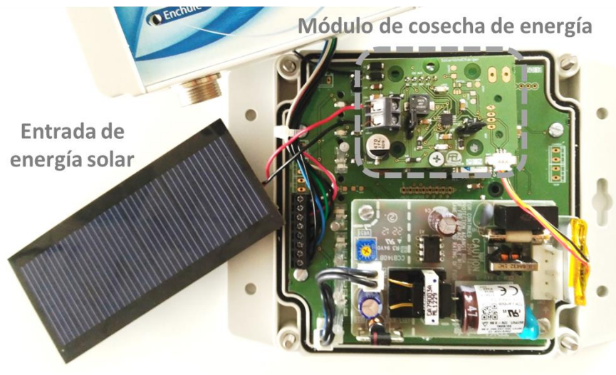
Figura 2.14. Modulo cosechador de energía en el interior de un nodo.
