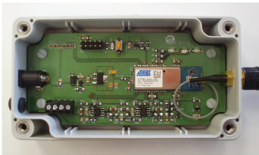
Figura 2.6. Interior del prototipo del nodo sensor de la red.
