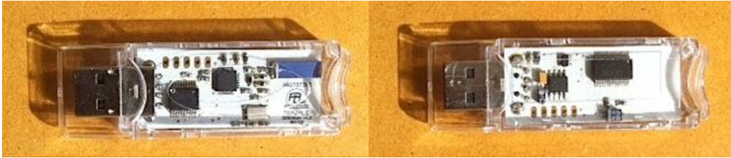
Figura 2.17. Dispositivo USB para el enlace de comunicación por radiofrecuencia.
