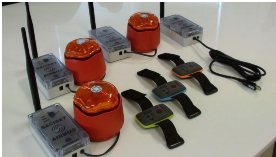
Figura 2.11. Dispositivos fijos y móviles de la red desarrollada.
