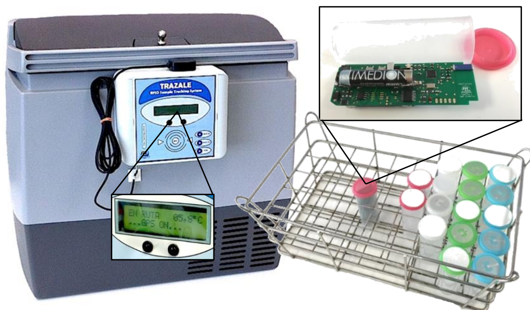
Figura 2.16. Sistema inalámbrico de trazabilidad para el proceso de recogida de muestras.
