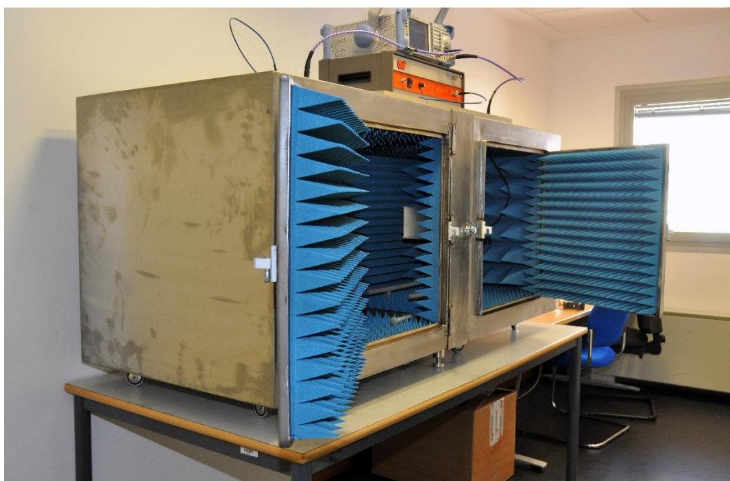
Figura 3.10. Equipo de medida electromagnética de materiales completo.
