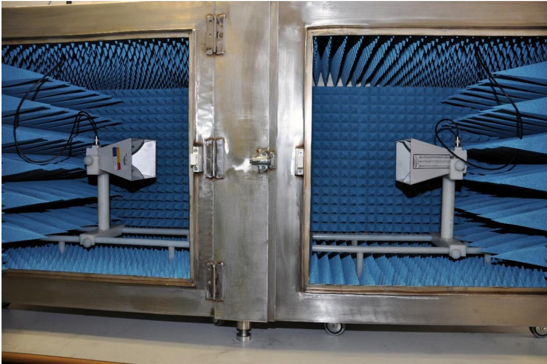
Figura 3.11. Disposición de las antenas en el interior de la cámara para la medida.
