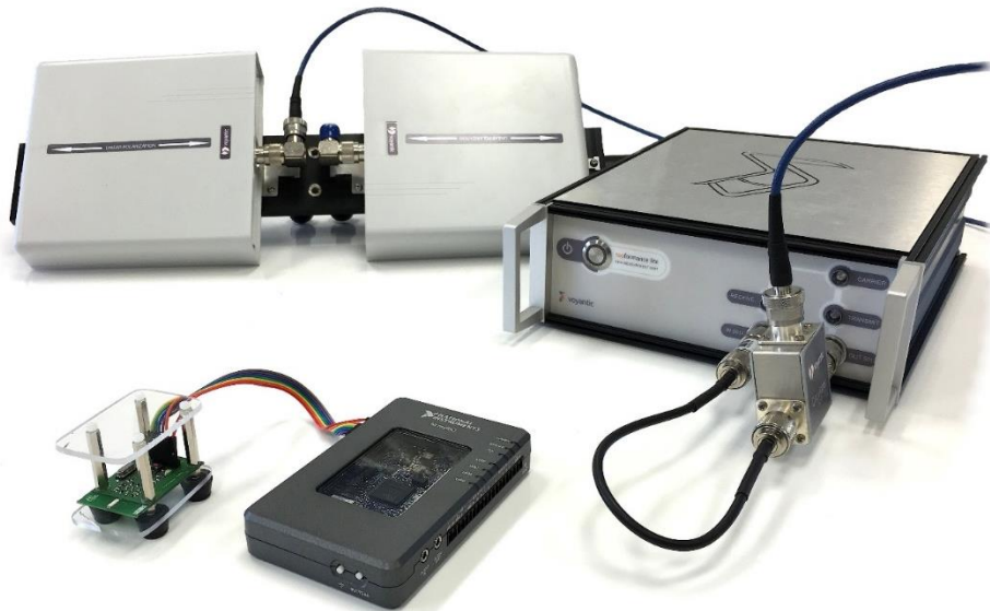
Figura 4.20. Plataforma con el emulador de etiquetas basado en myRIO y el sistema de medida empleado como lector.
