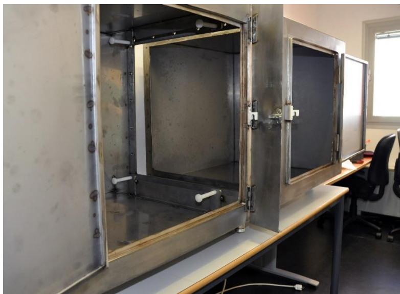
Figura 3.7. Estructura metálica y acabado de la cámara diseñada y fabricada.
