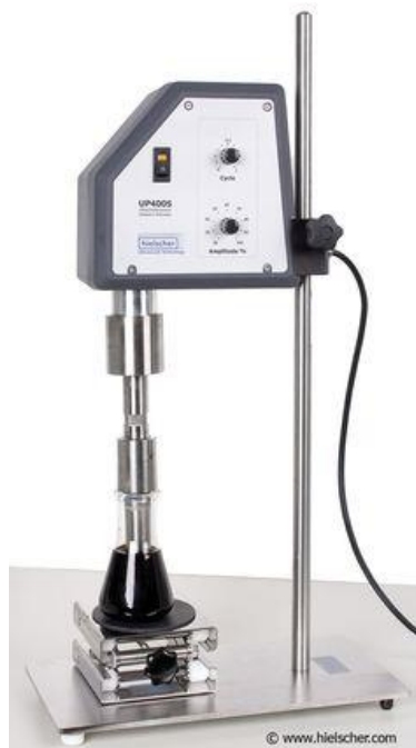
Figura 2.6. Equipo utilizado para la sonicación del óxido de grafito.
