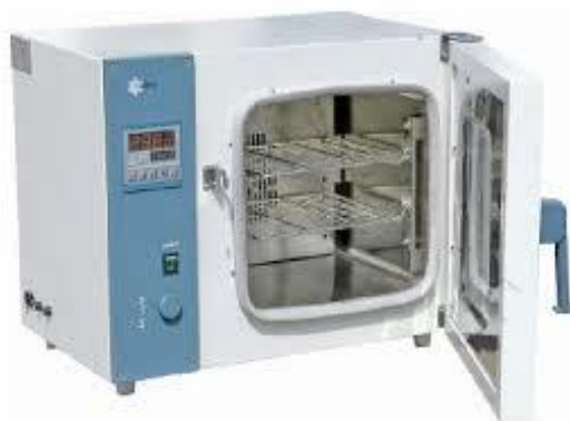
Figura 2.7. Estufa de secado utilizada en la síntesis de óxido de grafeno reducido térmicamente.
