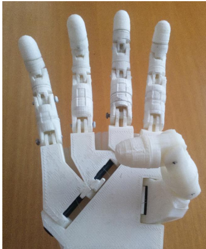
Figura 13 - Movimiento dedo pulgar. Imagen detalle sobre la prótesis realizada.
