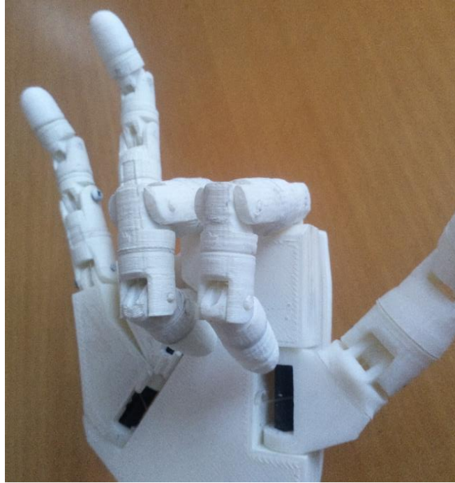
Figura 14 - Movimiento dedos índice y corazón. Imagen detalle sobre la prótesis realizada.
