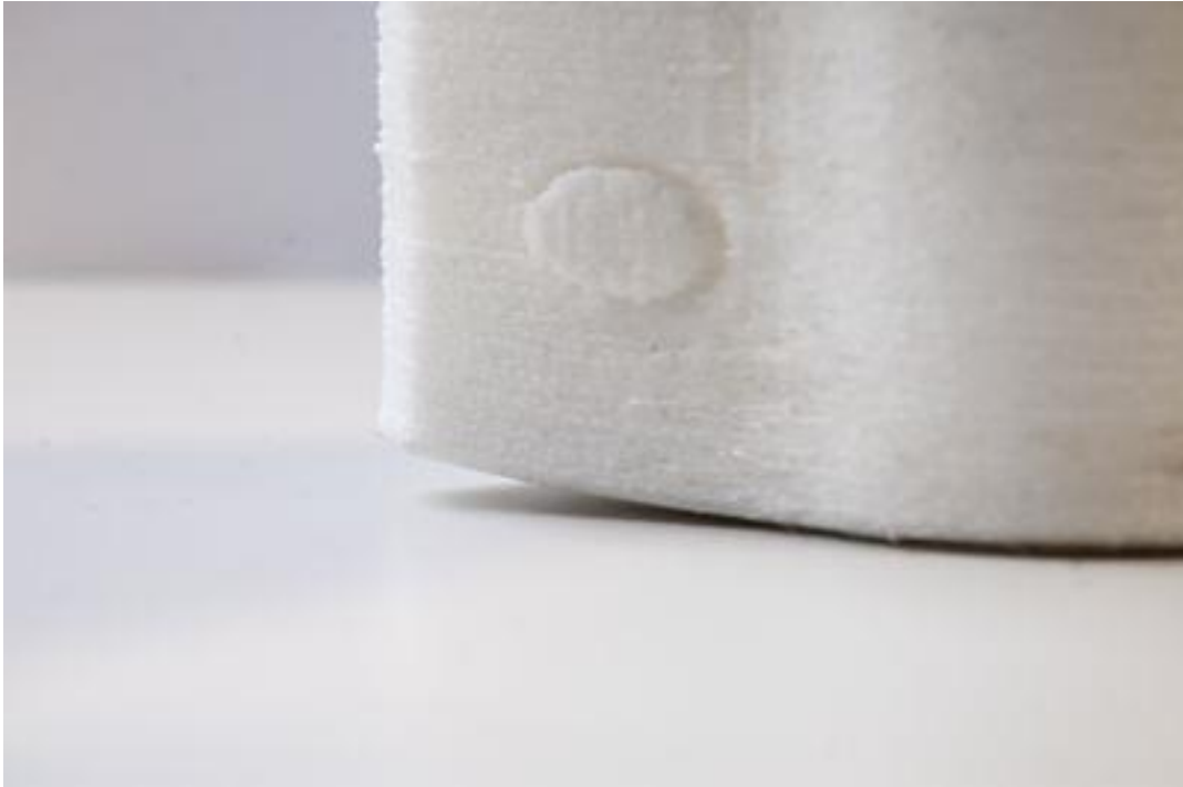
Figura 6 - Levantamiento de la base (Warping).
