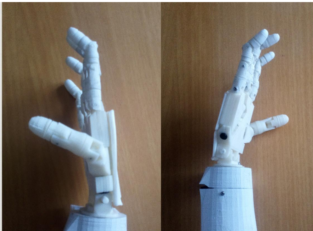
Figura 17 - Giro muñeca. Imagen detalle sobre la prótesis realizada.
