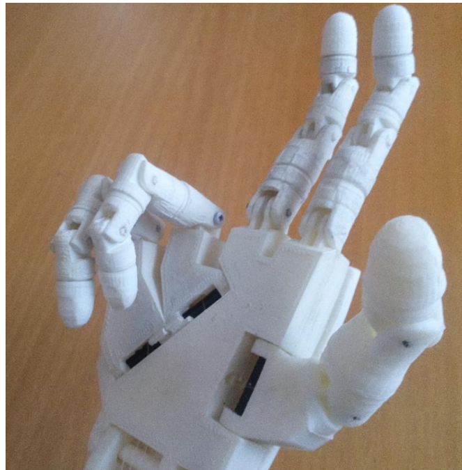
Figura 15 - Movimiento dedos anular y meñique. Imagen detalle sobre la prótesis realizada.
