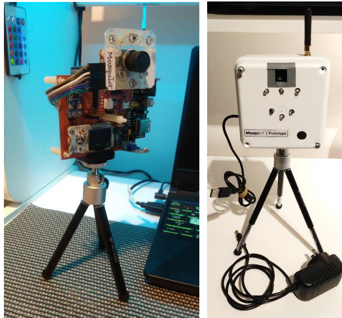
Fig. 21 Izquierda: Prototipo de MosquIoT en proceso de desarrollo. Derecha: Prototipo de MosquIoT finalizado (versión laboratorio)
