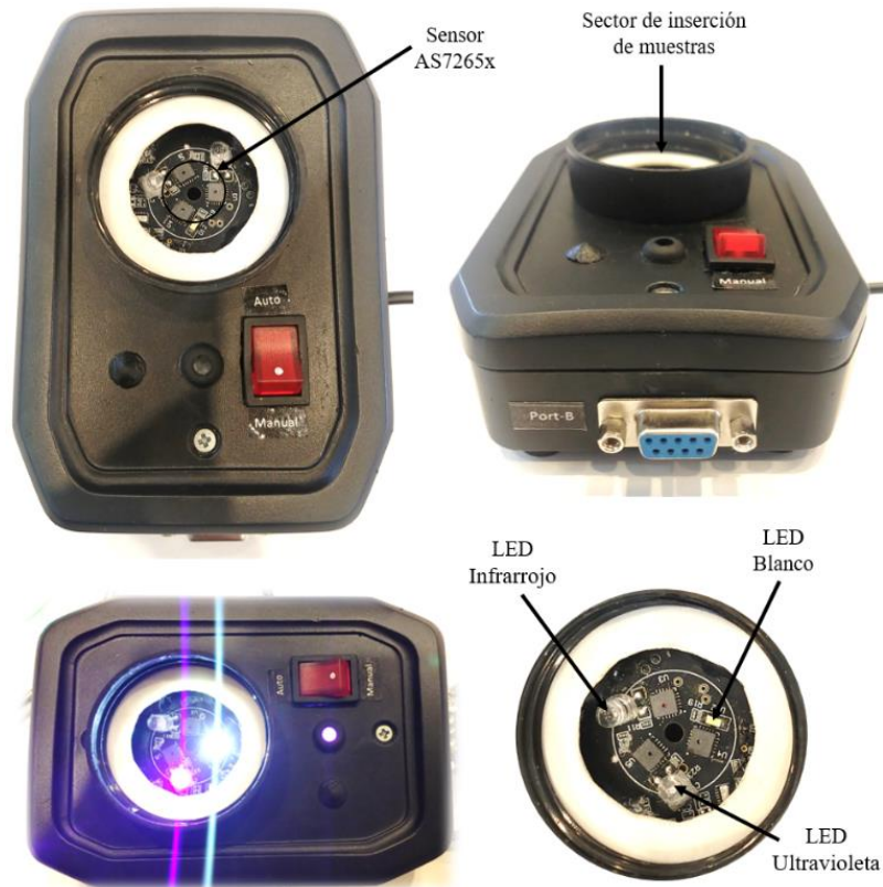
Fig. 9 SpectroGLY (Módulo de Sensado): sensor AS7265X, obturador y LEDs
