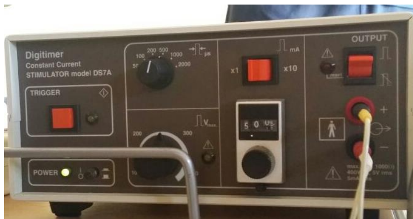
Imagen 7. Estimulador eléctrico (Digitimer). Fuente Propia.
