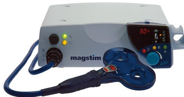
Imagen 6. Estimulador Magstim 200 con bobina magnética en forma de 8. Fuente: Google Imágenes.
