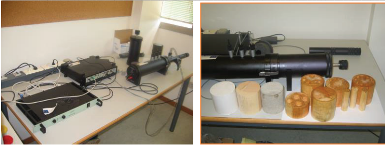
Figura 3. Dispositivo experimental. Consta de tubo de impedancias y sistema PULSE.
